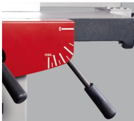
Die Spanabnahme wird über einen Handhebel an der Maschinen-Vorderseite eingestellt!
