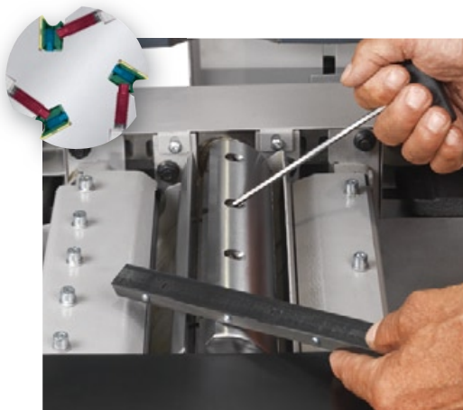
Die selbsteinstellende Hammer 3-Messer-Automatik-Hobelwelle!
