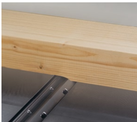
Spanabnahme bei Abrichtarbeiten bis max. 4 mm!
